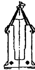
Схема строповки станины
